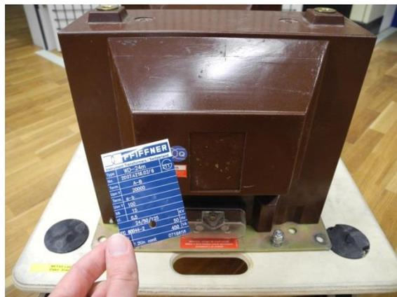
Fig.12: Les transformateurs de type WD-24m. La plaquette signalétique n'est pas suffisamment sûre, car elle s'est détachée de l'instrument.
