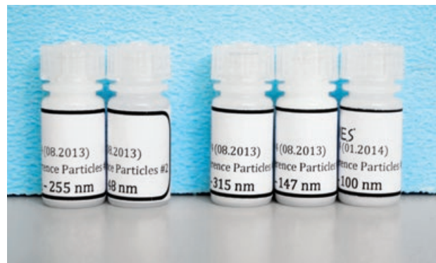
3: Echantillons de nanoparticules en solution avec une population monodisperse utilisés pour la comparaison inter-laboratoire.
